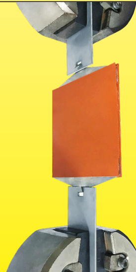
Equipo de prueba de fuerza de desgarro
