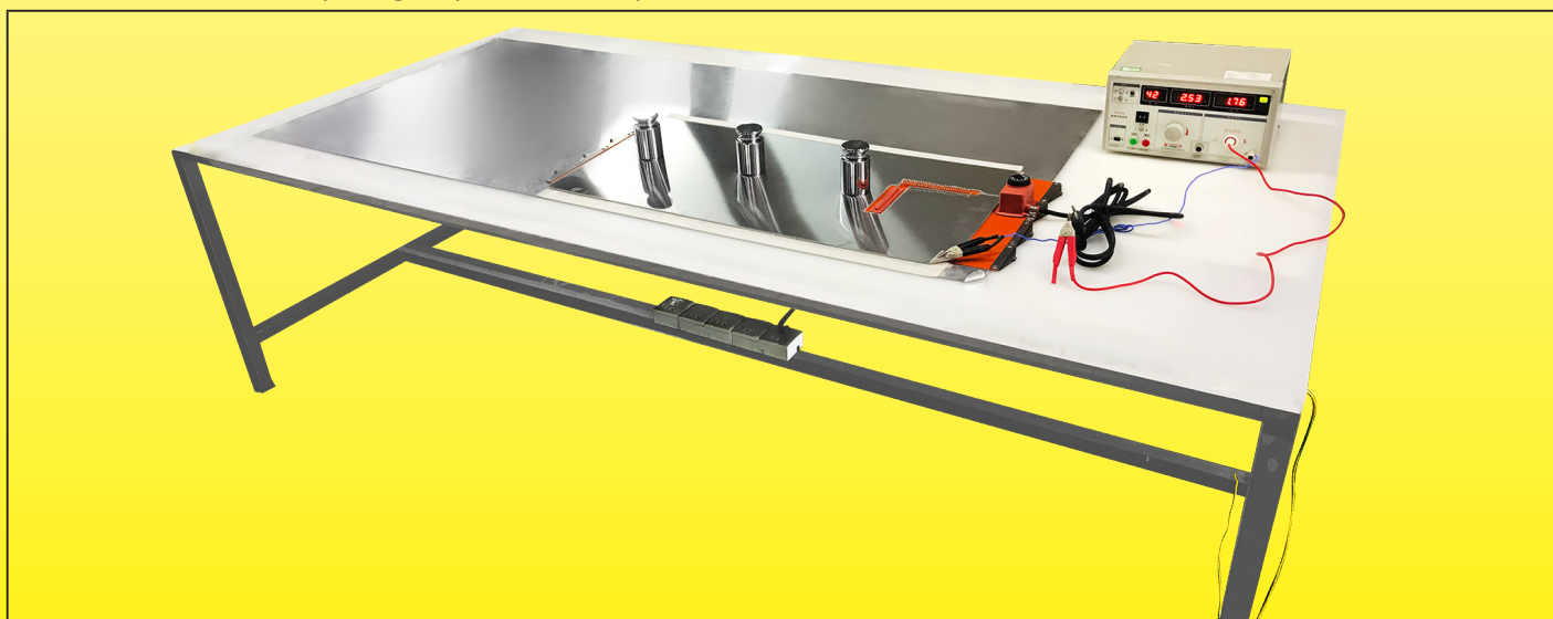
Equipo de medición para la corriente total de fuga en frío
